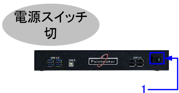
[図 6-2] 電源切断手順
