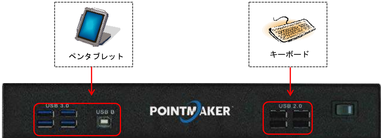
[図 5-2] 制御デバイスと接続したときの接続例
