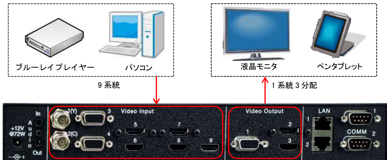
[図 5-1] ソース機器とシンク機器を接続したときの接続例
